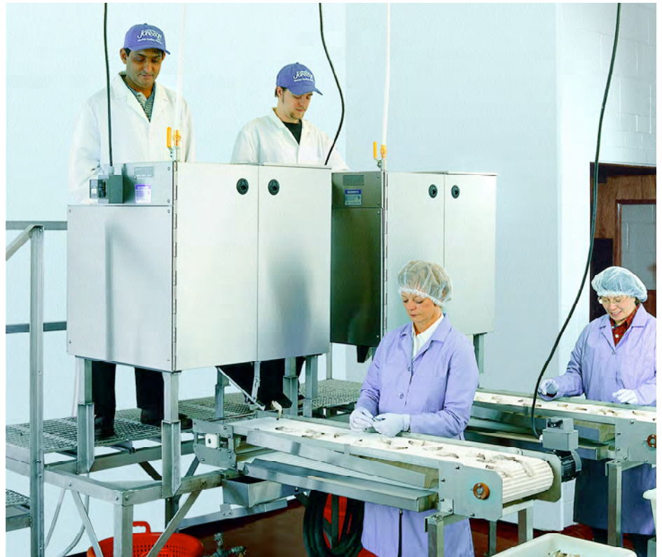
Sistemas de Peladura de Conservacion de agua, como la estacion doble enseñada arriba, use de 50 hasta 70% menos agua que con un sistema estandar.
